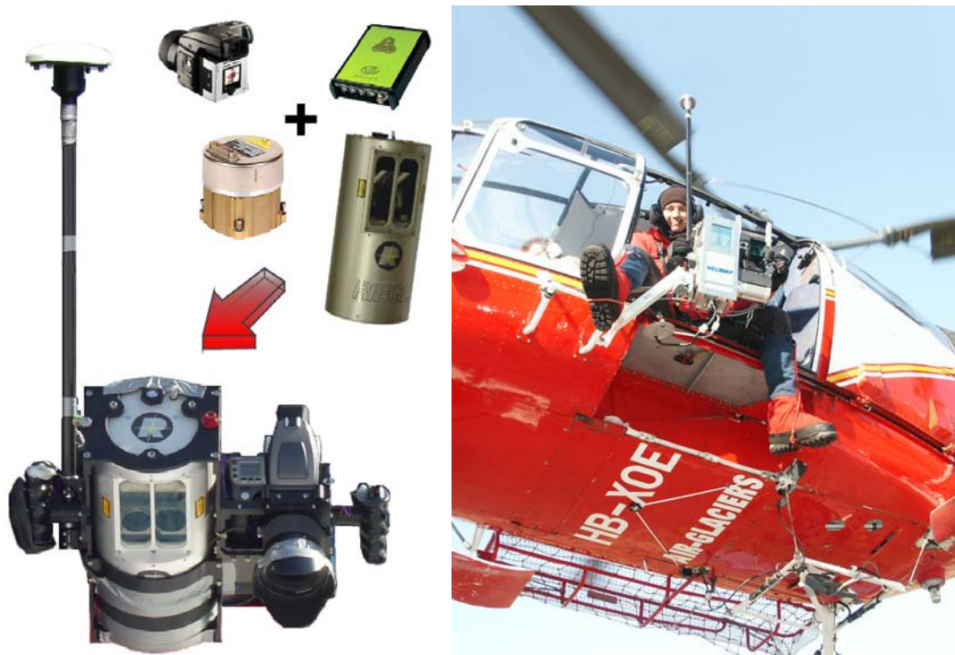
Figure 2: Le système Helimap et ses composants, son montage sur une Alouette III.
